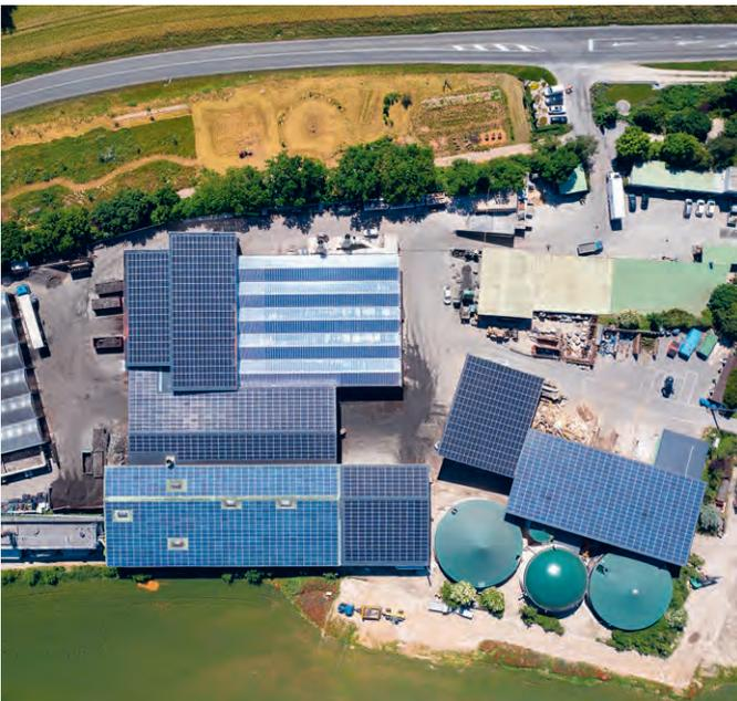
Ecorecyclage SA, qui produit du biogaz à partir de déchets verts et alimentaires ainsi que du compost, a complété sa production d'énergies renouvelables par l'installation de quelque 2'500 m<sup>2</sup> de panneaux solaires photovoltaïques supplémentaires, portant ainsi la surface solaire totale du site à 5'000 m<sup>2</sup>.
